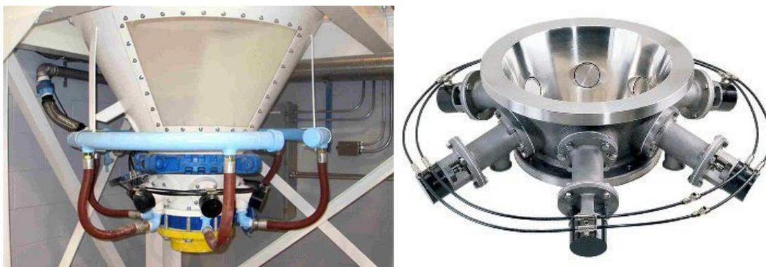
Рисунок 1.14 Пневмосмеситель NOL-TEC
