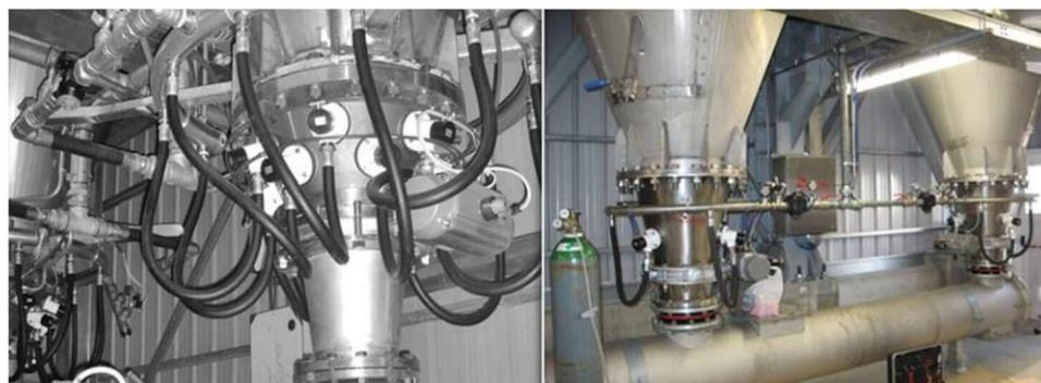
Рисунок 1.15 Пневматический смеситель Petrosadid
